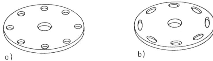
Figura 4. Discos de sementes com diferentes tipos de alvéolos: a) circulares, b) oblongos.
